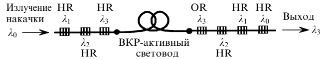
Рис.1. Схема трехкаскадного ВКР-лазера: HR (OR) – брэгговские решетки показателя преломления с высоким (оптимальным) коэффициентом отражения на указанных длинах волн; • – точки сварки световодов.
