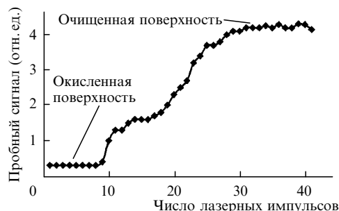
Рис.3. Изменение пробного электрического сигнала в процессе очистки поверхности от окислов.
