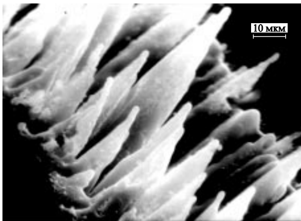
Рис.3. Микроструктуры, растущие при наклонном падении лазерного излучения на поверхность кремния в вакууме под углом 60^\circ .
