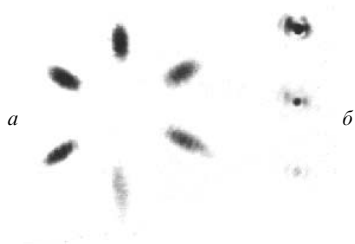
Рис.11. Изображение в дальней зоне излучения, формируемое только одним ГЗ системы ТЕНОКОМ без компенсации влияния взаимного наклона субапертур (а) и всей системой ТЕНОКОМ с использованием того же ГЗ (б; даны три изображения, зарегистрированные с разным ослаблением).
