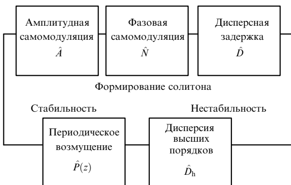
Рис.9. Схема, поясняющая расположения элементов в резонаторе и действие соответствующих операторов.
