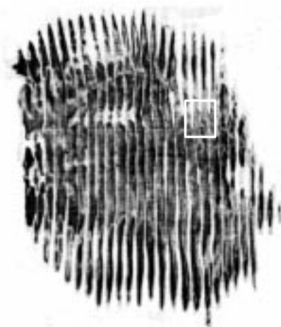
Рис.5. Интерферограмма поперечного сдвига лазерного пучка. Рамка на поле указывает положение дислокации.
