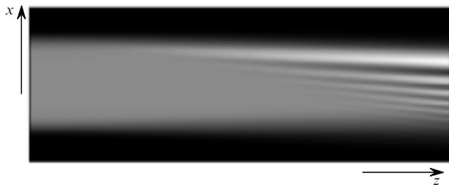
Рис.5. Распределение интенсивности светового пучка с «прямоугольным» профилем при распространении в кристалле длиной 15 мм вдоль оси  $z$  для  $m = 0.5$ ,  $E_m = 5$  кВ/см,  $I_d = 0.01$  и  $\mu\tau_r = 2 \times 10^{-12}$  м<sup>2</sup>/В. Масштаб по поперечной оси  $x$  увеличен в 14 раз.
