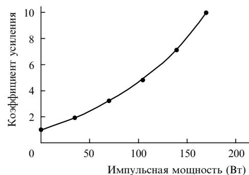
Рис.8. Зависимость коэффициента усиления слабого сигнала ( $P_{out}/P_{in}$ ) на  $\lambda = 1064$  нм в кристалле Nd : YAG от импульсной мощности накачки диодной матрицей.
