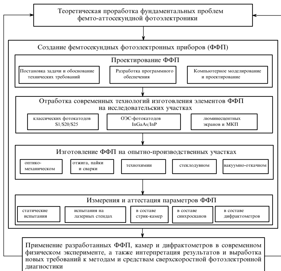
Рис.11. Блок-схема исследовательско-технологической цепочки для проектирования, разработки и изготовления фемтосекундных ЭОПов, камер и дифрактометров (Отдел фотоэлектроники ИОФАНа).
