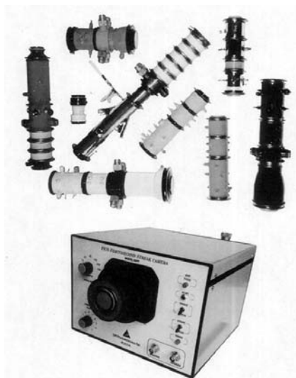
Рис.12. Пико-фемтосекундные ЭОПы, фотоэлектронные пушки и камеры, разрабатываемые и изготавливаемые в Отделе фотоэлектроники ИОФАНа.
