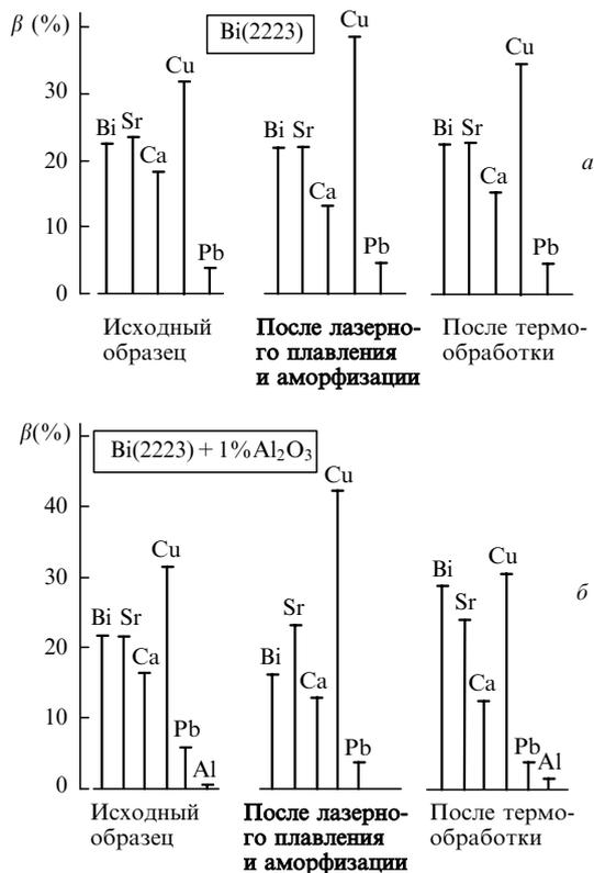
Рис.6. Элементный состав, определенный с помощью микроанализатора LINK, на различных стадиях лазерной и термической обработки для образца Bi(2223) (а) и для образца Bi(2223), легированного Al<sub>2</sub>O<sub>3</sub> (массовая доля 1 %) (б).
