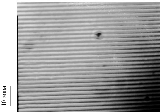
Рис.10. Фотография поверхности пластины ПММА с периодом структуры 1.8 мкм.
