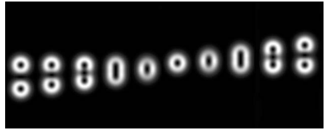
Рис.3. Интерференция двух пучков моды ЛГ с одинаковыми поляризациями (расчет). Расстояние между пучками дано в долях w_0 .
