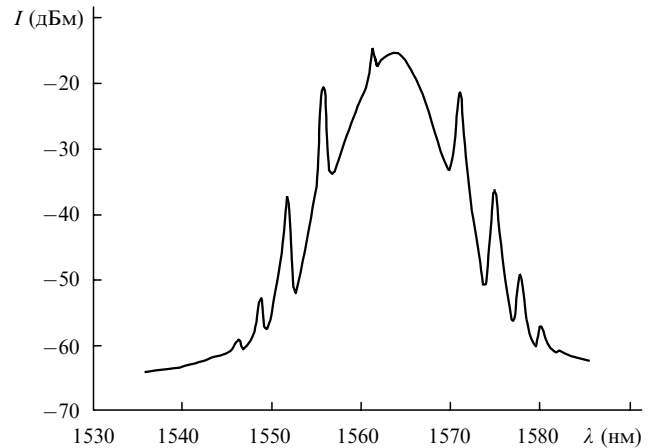
Рис.5. Спектр генерации в солитонном режиме.
