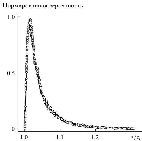
Рис.4. Расчетная времяпролетная характеристика: ось времени нормирована на  $\tau_0$  – время баллистического (без рассеяния) пролета; быстрый алгоритм расчета.
