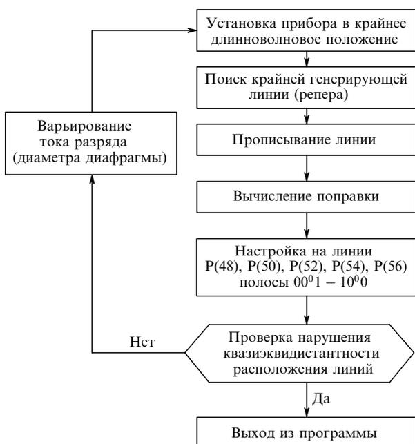
Рис.3. Схема алгоритма нахождения экспериментальной поправки.
