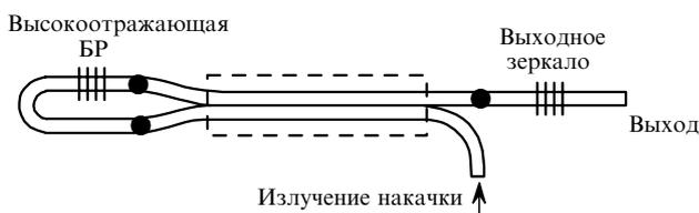
Рис.7. Схема лазера на двухэлементном МПО-световоде с возвратом излучения накачки.
