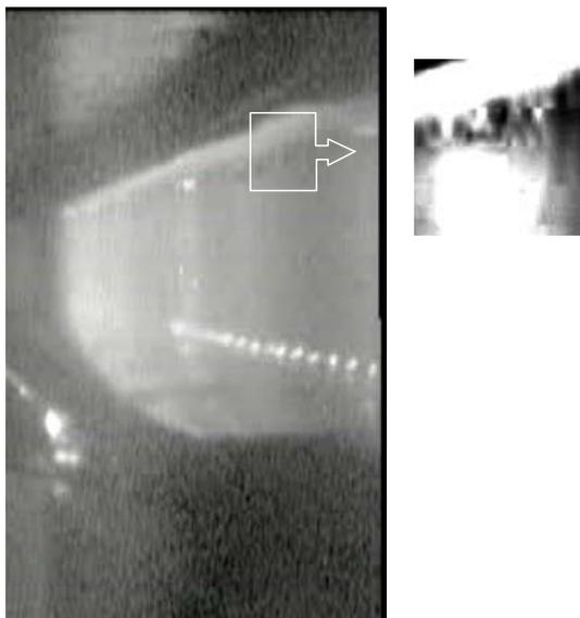
Рис.4. Интегральное по времени свечение разряда для смеси Ne:He:HCl = 1000:15:1 с давлением  $p = 4$  атм при  $C_1 = 36.5$  нФ,  $C_2 = 22.4$  нФ,  $R_c = R_a = 30$  мм и  $U_0 = 23$  кВ. Справа – увеличенный фрагмент участка разряда.
