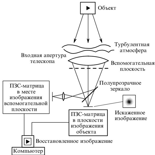
Рис. 1. Схема наблюдения объектов с восстановлением аппаратной функции по распределению интенсивности во вспомогательной плоскости.
