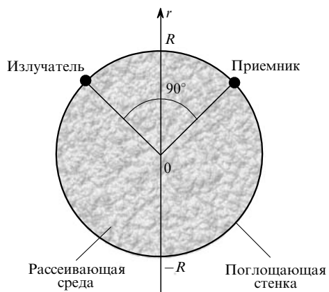
Рис.4. Центральные сечения распределений вероятности P_{\Sigma}(r) прохождения фотонов (а) и геометрия эксперимента (б). Расчет проведен методами Монте-Карло ( \square ) и интегрирования по путям при \langle \Delta z \rangle = 8\mu_s^{-1} и k_{\text{eff}}(\Delta z) , определенном через \langle k \rangle(\Delta z) (пунктирная кривая) и из выражения (12) (сплошная кривая).
