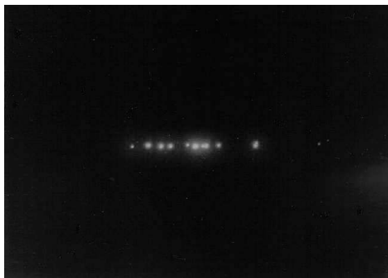
Рис.1. Картина множественного пробоя воды, полученная с помощью оптического микроскопа, при длительности импульса 50 нс.
