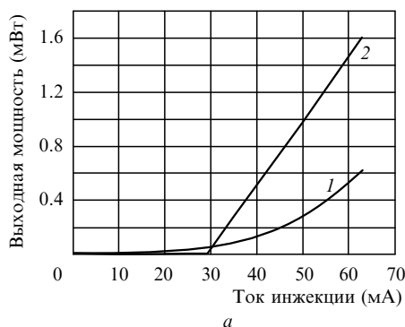
Рис.5. Ватт-амперные характеристики (а) и спектры выходного излучения (б) ПЛУ до помещения его во внешний резонатор (1) и в стационарном лазерном режиме (2) при настройке АОПФ на \lambda = 860 нм (а) и 840 нм (б).
