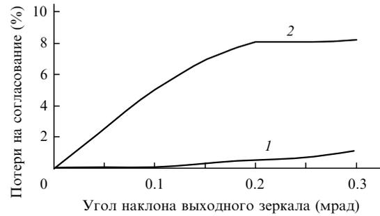
Рис.8. Результаты численного расчета потерь для волноводного (1) и неустойчивого (2) направлений в зависимости от угла наклона (расточки) выходного зеркала в соответствующих направлениях в случае резонатора первого типа.
