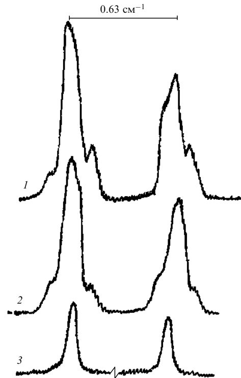
Рис.5. Интерферограммы лазерной линии ртути ( \lambda = 546.1 нм), усиленной в красителе (1) и инжектированной в краситель (2), а также линии генерации He-Ne-лазера (3). Интенсивности приведены в произвольных единицах.
