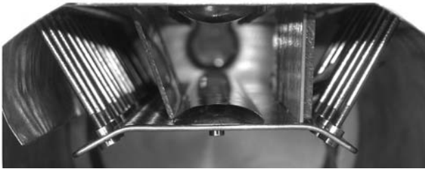
Рис.1. Фотография разрядного промежутка лазера с установленными шаблонами.
