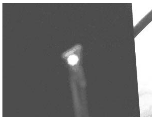
Рис.56. Иллюстрация эффекта удвоения частоты глобулярным фотонным кристаллом, заполненным MNA. Фотография излучения второй оптической гармоники ( \lambda = 532 нм), возбуждаемой лазером на алюмоиттриевом гранате.
