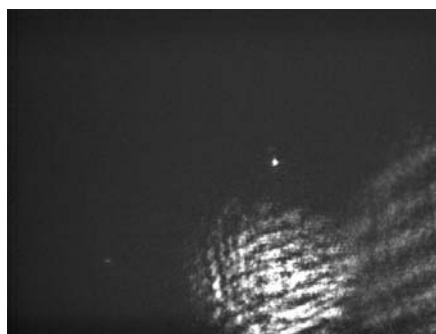
Рис.5. Дальняя зона искаженного и исправленного пучков; аберратор – сферическая линза.
