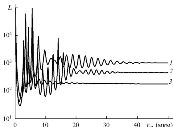
Рис.4. Лидарное отношение  $L$  в зависимости от среднего радиуса аэрозольных частиц  $r_m$  для длин волн 11.7 мкм ( $m = 1.206 - i \times 0.17$ ) (1), 10.6 мкм ( $m = 1.237 - i \times 0.087$ ) (2) и 9.6 мкм ( $m = 1.357 - i \times 0.089$ ) (3).
