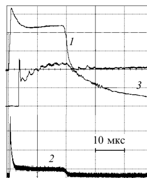
Рис.8. Осциллограммы огибающей импульса СВЧ накачки (1), импульса сигнала с ФЭУ, соответствующего свечению плазмы в газоразрядном промежутке (2), и лазерного импульса (3).
