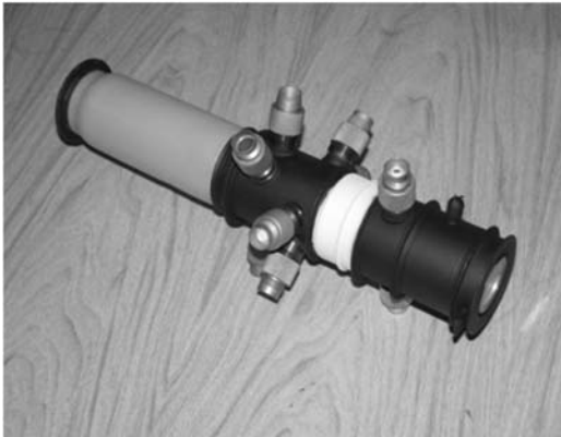
Рис.4. Фотоэлектронная пушка с динамической фокусирующей линзой для экспериментов по электронной дифракции с временным разрешением.
