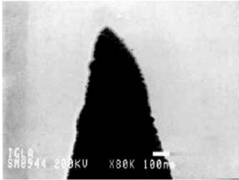
Рис.4. СЭМ-изображение суженного оптического волокна.
