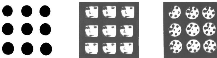
Рис.12. Растр миниатюрных линз (3 × 3), изготовленных методом ЛАСК, и фотографии объектов, снятых с его помощью (толщина пластинки h = 0.6 мм, q \approx 2 \times 10^6 Вт/м 2 , T_0 \approx 600 К); фокусное расстояние линз F = 21 мм, его разброс в растре \Delta F = 3\% .
