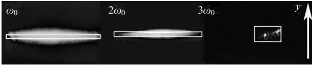
Рис.5. Распределения плотности энергии излучений гармоник на CCD-матрице.
