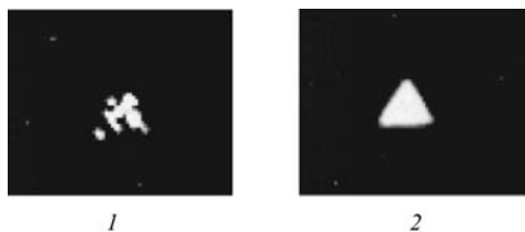
Рис.7. Улучшенное изображение плоского треугольного шероховатого объекта, полученное путем накопления статистически независимых когерентных изображений, сформированных в результате одновременного зондирования объекта несколькими источниками: 1 – исходное когерентное изображение объекта, состоящее из семи контрастных пятен; 2 – его улучшенное изображение, сформированное путем накопления десяти статистически независимых когерентных изображений.
