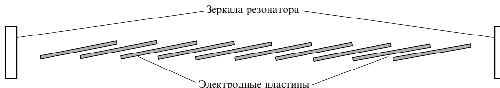
Рис.11. Схема расположения электродных пластин в лазере с увеличенной энергией импульса.
