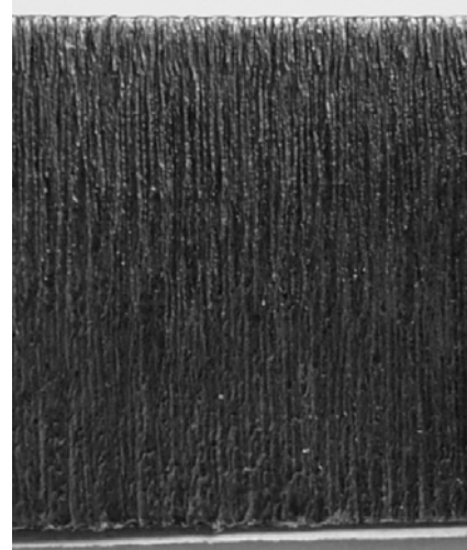
Рис.10. Поверхность реза коррозионно-стойкой стали; t = 12 мм.
