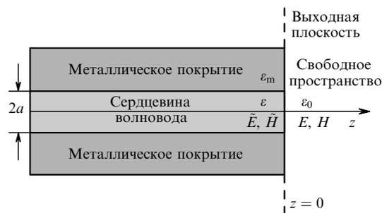
Рис. 1. Схематическое изображение поперечного сечения цилиндрического волновода с металлическим покрытием:  $2a$  – диаметр выходной апертуры,  $\epsilon$ ,  $\epsilon_m$  и  $\epsilon_0$  – диэлектрические проницаемости сердцевины волновода, металлических стенок и окружающей среды.
