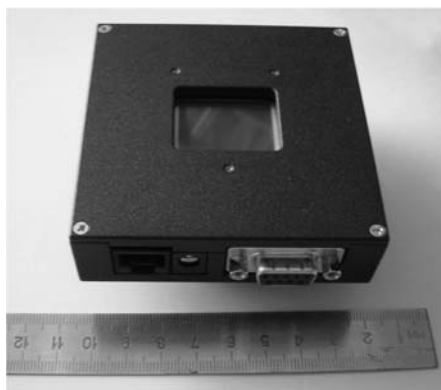
Рис.2. ЖК модулятор Holoeye-SLM-LC-2002.
