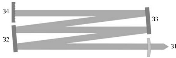
Рис.5. Схема резонатора технологического CO<sub>2</sub>-лазера: 31 – выходное зеркало из селенида цинка, радиус кривизны  $R = 30$  м; 32, 33 – поворотные плоские зеркала; 34 – поляризационно-селективный элемент (дифракционное зеркало или аксикон).
