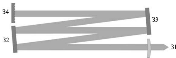
Рис.5. Схема резонатора технологического CO<sub>2</sub>-лазера:
