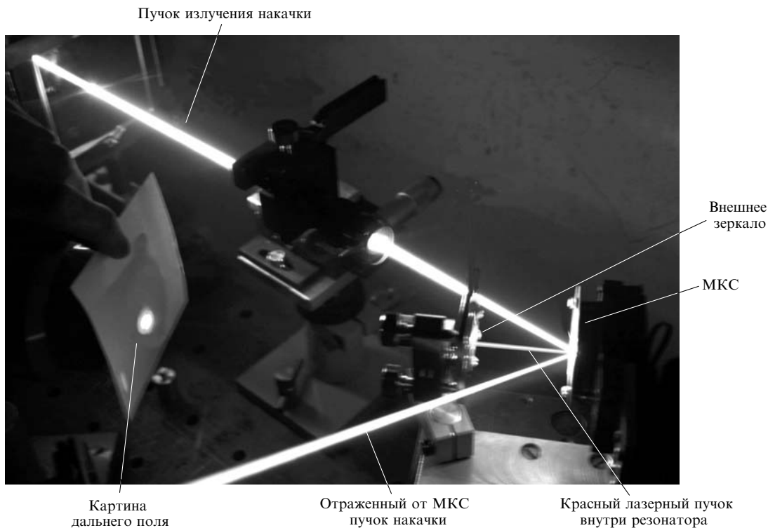
Рис.3. Фотография действующего макета лазера.
