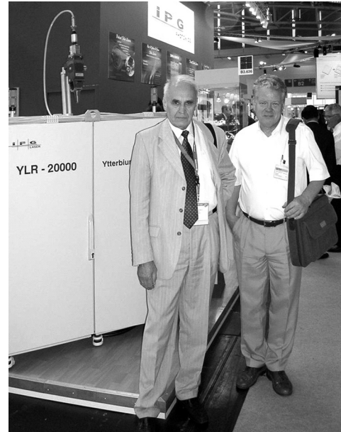
Рис.4. Волоконный лазер фирмы IPG (YLR-20000) мощностью 20 кВт.
