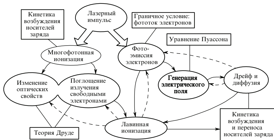
Рис.2. Схематичное представление лазерно-индуцированных процессов в диэлектрических материалах (в овальных рамках). В квадратных рамках даны соответствующие подходы к описанию процессов. Стрелками показаны основные взаимосвязи между различными процессами (сплошные линии – для прямых эффектов, штриховые – для обратного влияния).
