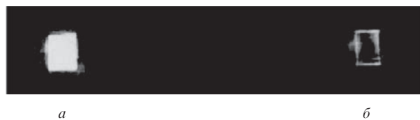
Рис.1. Фотографии изображения прямоугольной щели в нулевом дифракционном порядке (а) и его контура, полученного в первом порядке дифракции (б).
