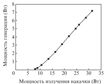
Рис.3. Зависимость выходной мощности лазера от мощности накачки.
