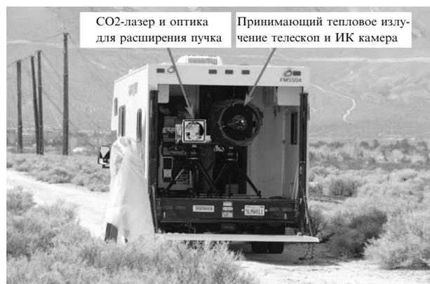
Рис.13. Фотография экспериментального образца оптотермического сенсора ROSE для standoff детектирования ВВ [116].
