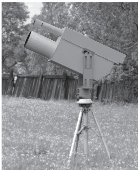
Рис.1. Внешний вид приемопередатчика лидара «ЛОЗА-М2».
