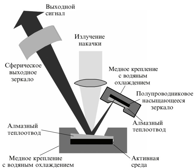
Рис.1. Схема дискового лазера с пассивной синхронизацией мод с накачкой под углом 25^\circ по отношению к плоскости резонатора ПДЛ.
