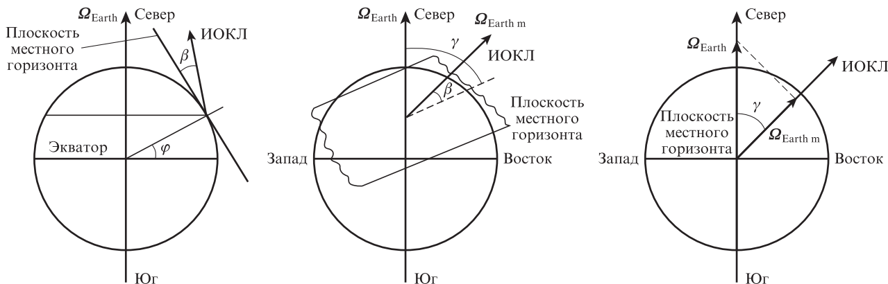
Рис.4. Схемы, иллюстрирующие определение направления на Северный полюс Земли (азимута) с использованием КЛ (ИОКЛ – измерительная ось КЛ).
