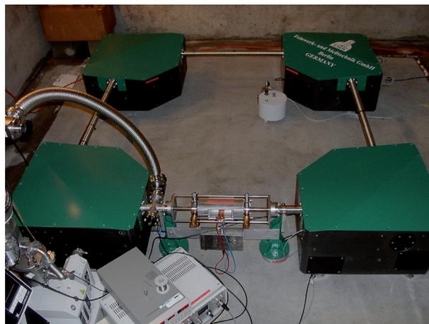
Рис.5. Конструкция узла с кольцевым лазером в GEOsensor. Для стабильности гетеролитическая структура жестко крепится на бетонной плите толщиной 30 см.
