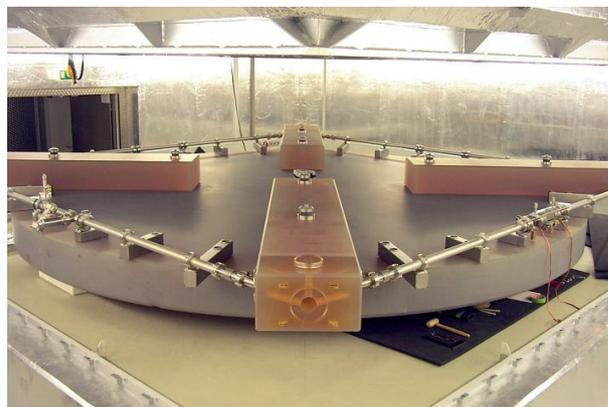
Рис.1. Конструкция кольцевого лазера G в подземной лаборатории геодезической обсерватории г. Ветцель (Германия).
