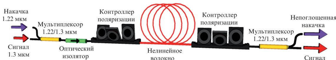
Рис.7. Схема волоконного ВКР-усилителя, работающего в сонаправленном режиме.
