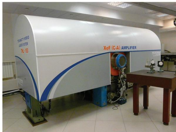
Рис.1. Внешний вид XeF(C–A)-усилителя.
